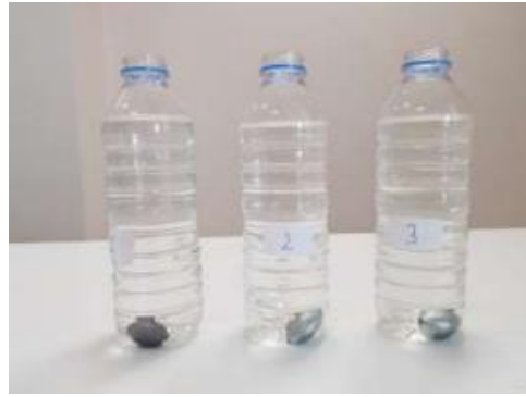
Şekil 7. Ürünlerin deniz suyuna konduğundaki durumları (Soldaki şişe, piyasada kullanılan balıkçı kurşunu; ortadaki şişe, balıkçı kurşunuyla aynı hacme sahip demir ürün; sağdaki şişe, balıkçı kurşunuyla aynı kütleye sahip demir ürün içermekte.)
