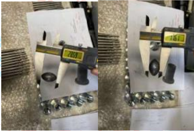
Şekil 2. Kurşunların ölçümlerinin yapılması
