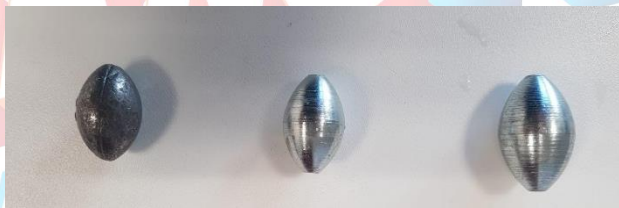
Şekil 10. Ürünlerin 150 saat deniz suyu bekletildikten sonraki durumları
