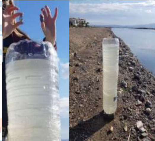
Şekil 8. Deniz suyu ile dolu olan, viskozite deneyinin yapımında kullanılan 1 metre uzunluğundaki sistem
