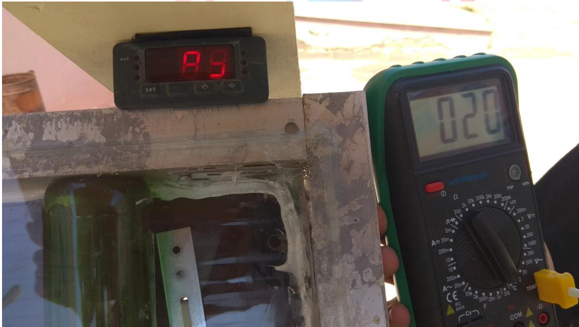
GÜNEŞ SOBASI ÇIKIŞ SICAKLIĞI (89) VE DIŞARIDAKİ HAVANIN DERECEİ (20)
