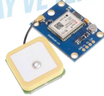
Şekil 10: GY-NEO6MV2 GPS Modülü
