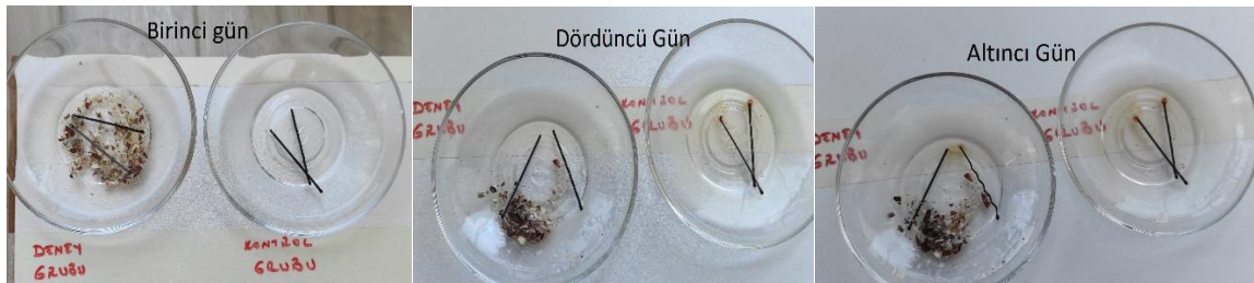
Resim 8. Kitin bazlı solüsyonun metallerdeki korozyona etkisi
