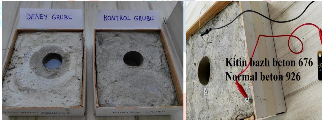
Resim 7. Hidrofobik özelliğinin görsel olarak gözlemlenmesi ve microbit ile ölçülmesi
