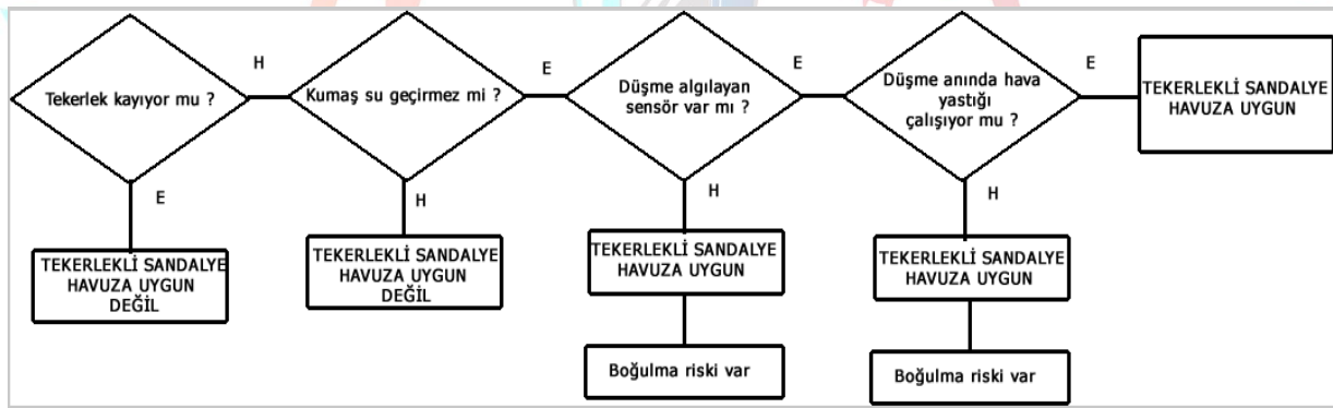
Şekil 3 Tekerlekli sandalye tasarımına yönelik akış şeması
