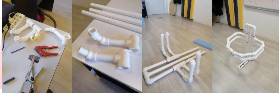
Şekil 2. PVC boruların birleştirilmesi ve gövde iskeletinin oluşturulması.
