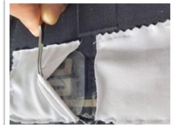
Şekil 5 Membranların ısıtıcı kumaşa ceplerle sabitlenmesi
