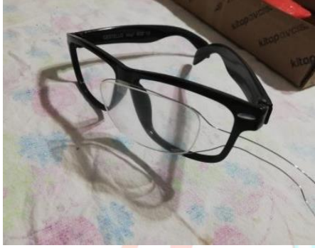
Şekil 3. Isıtıcı telin gözlük camına yerleştirilmesi Şekil 4. Anahtar devre kontrolü
