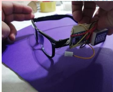
Şekil 7. Gözlük sapına grubun bağlantısı
