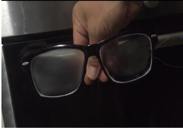
Şekil 2. Devre açıldıktan 2 dak. sonra gözlüğün buğulanan(sağ) ve buğulanmayan(sol) camları
