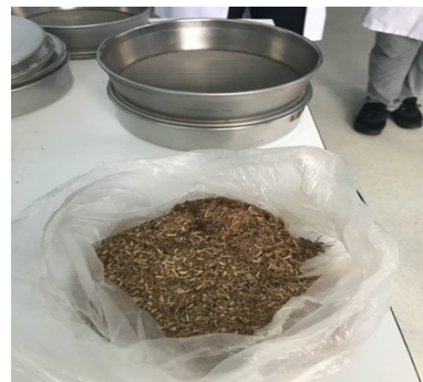
Şekil 2. Numunelerin elekten geçirilmesi
