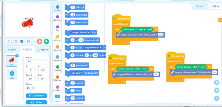
Resim 13:Kamera görüntüsü tanımlamasına göre makeblocktan arduinoya iletilecek komutlar.
