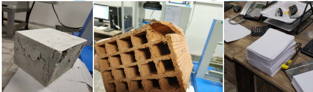
Şekil 4.2. Basınç dayanım testi sonrası malzemelerde meydana gelen deformasyon.
