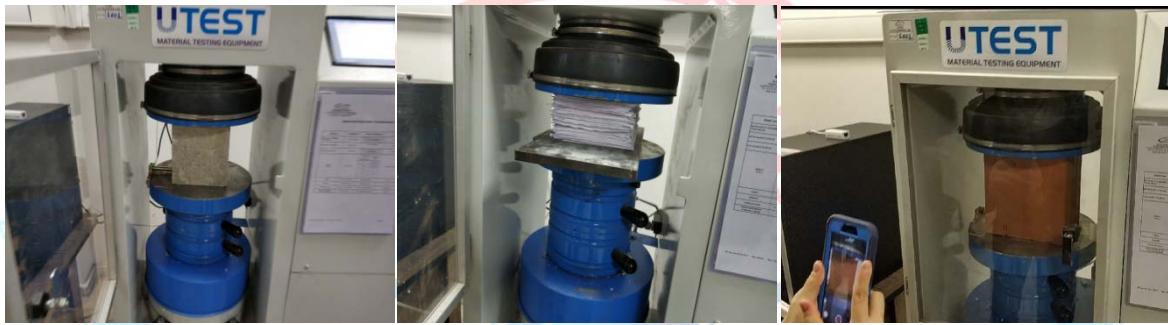
Şekil 4.1. Sırasıyla C50 beton, A5 kağıt ve tuğla basınç dayanım testi.
