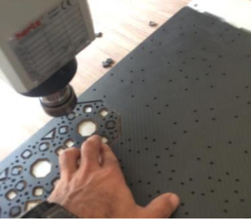
Şekil 5. CNC karbonfiber kesimi
