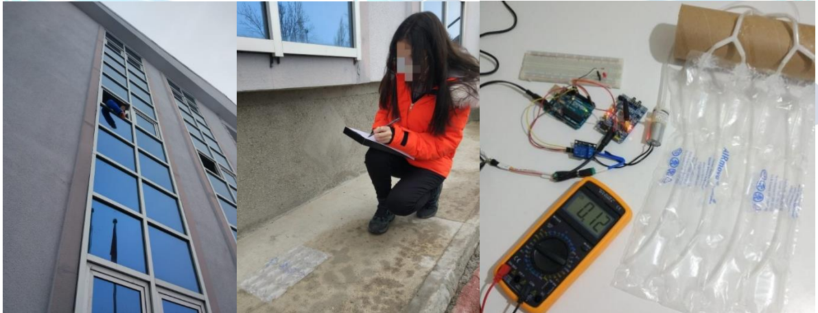
Şekil 5: Düşme Darbe Testi Ve Akım Değerlerini Gösteren Görseller
