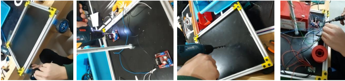
Şekil.6 Gövdeye Motor ve Taşıyıcıların Bağlanması
