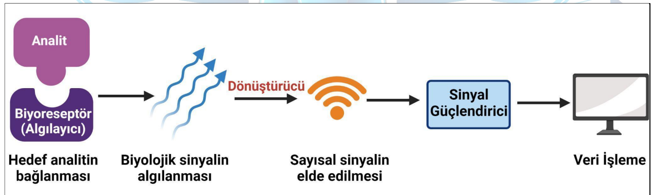
Şekil 3.: Analit, Biyoreseptör ve Dönüştürücüden Oluşan Tipik Bir Biyosensör Şeması
