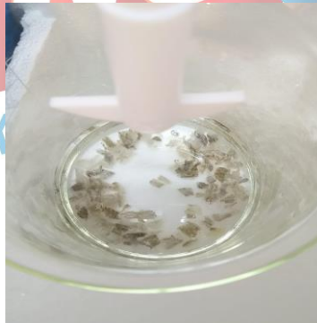
Şekil 8. Balık derisinin asetik asit içerisinde çözündürme işlemi
